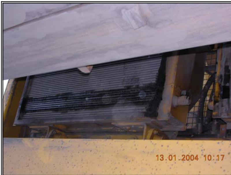
Рис. 6. Загрязнение поверхности масляного радиатора экскаватора РС-5500 агломератом пыли и масла
