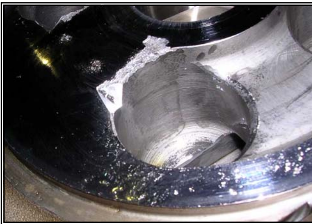
Рис. 4. Кавитационный износ распределительного диска гидромотора привода поворота (слева) и золотника гидрораспределителя подъема стрелы (справа)
