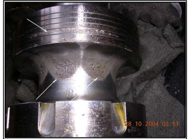
Рис. 4. Кавитационный износ распределительного диска гидромотора привода поворота (слева) и золотника гидрораспределителя подъема стрелы (справа)
