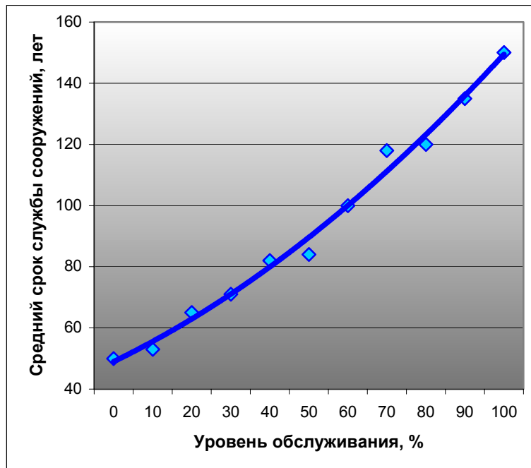
Рис.5. Зависимость срока службы мостов от уровня их обслуживания. 100% уровень соответствует полной и своевременной реализации всех регламентных и ремонтных работ.
