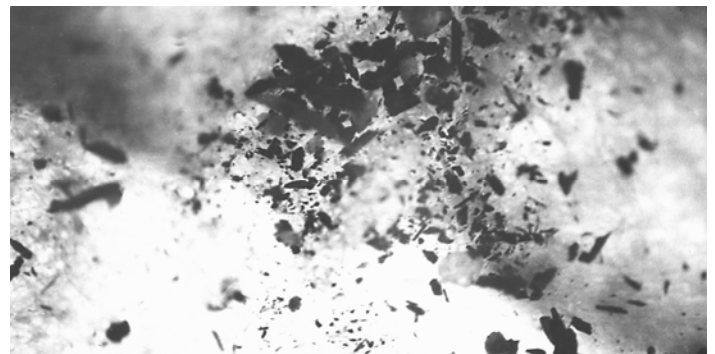
Рис.1.2. Микрофотография характерного осадка на фильтре гидравлической системы
