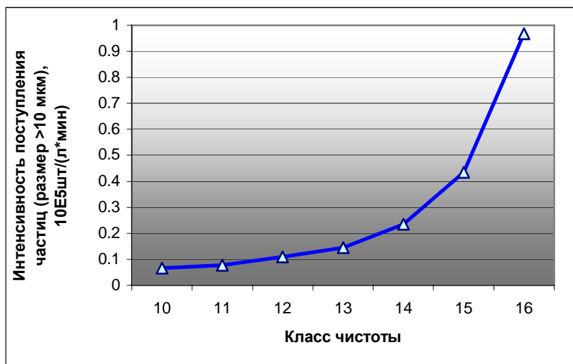
Рис.4.4. ИПЗ в зависимости от класса чистоты жидкости по ГОСТ 17216-71
