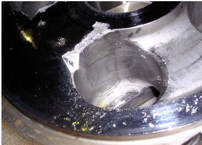
Рис. 11. Распределительный диск гидромотора поворота со следами кавитационного износа (гидропривод экскаватора)
