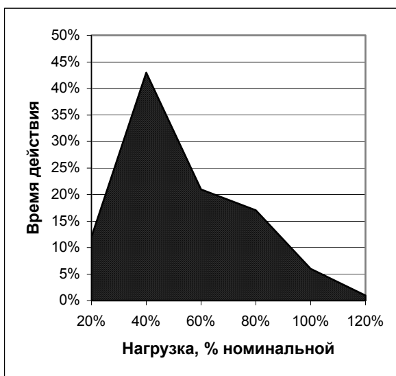
Рис. 4. Интерпретация результатов работы АФПу в режиме «Накопитель». На примере измерения нагрузки (первичные датчики – МД-400П).
